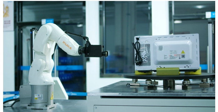
图二 集成了工业相机、用于执行缺陷检测的工业机器人
