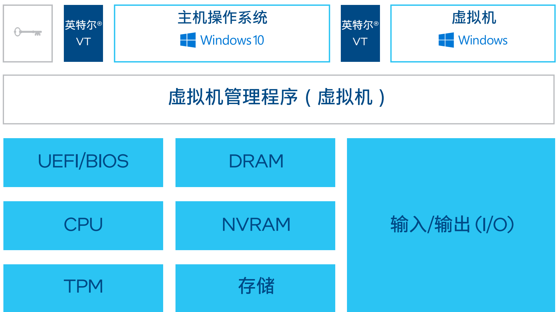
图 3. 英特尔® vPro® 平台上的英特尔® VT 支持工作负载隔离，通过支持创建隔离的虚拟机 (VM) 减少受攻击面，降低恶意软件在资源间持续传播的能力
