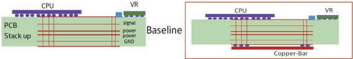
图注：传统提升供电布线方法（左）；电源汇流排技术提升供电布线方法（右）
