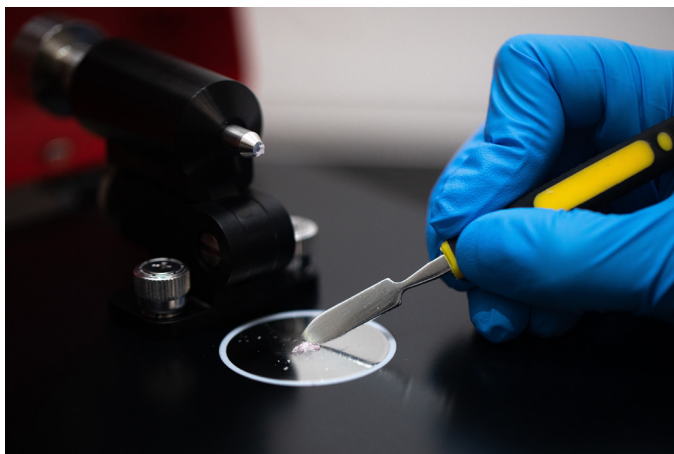
在红外吸收光谱测量中，将少量样本置于晶体上，红外光通过晶体反射。 图片来源: Jay Wallace
