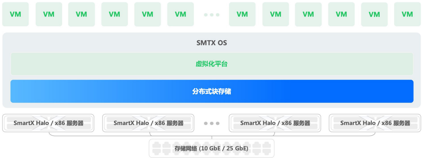
图 1. SMTX OS 超融合产品部署架构
